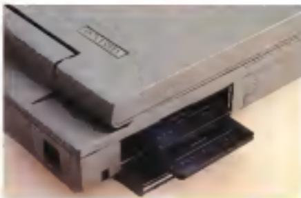
sattivati quando il computer funziona alimentato da rete, oppure che durante l'uso con una singola batteria, questa possa essere sostituita «al volo», semplicemente mettendo in stand-by il computer durante l'operazione.
